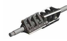
此刀辊采用多组错开一定角度的后置人字刀排布,减少切削冲击力, 适合用于破碎薄壁物料,如PET瓶等。
