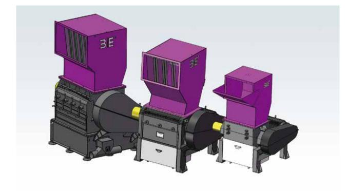
PC系列破碎机主要用于塑料、金属、纸张、电子垃圾、橡胶、轮胎等物料的破碎,破碎物的外形可以是块状胶头 料,薄膜,片材,管状、浇口料及各种外形的中空容器等。客户可针对不同物料的破碎需求选用不同的刀辊结构, 从而提高效能。同时客户可根据需求配备风送集料装置和隔音罩。此系列破碎的箱体为对开结构,清洗、换刀、维 修保养十分方便,具有经济适用,操作简易,使用寿命长等优点。
